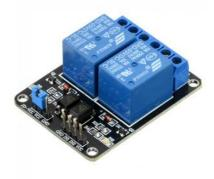
Fig2: Relay module
