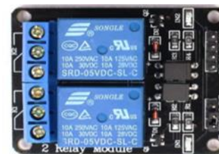
Fig: Relay Module
