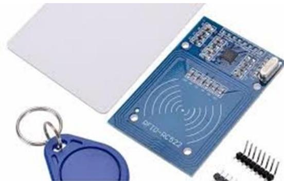
Fig 4. RFID module
