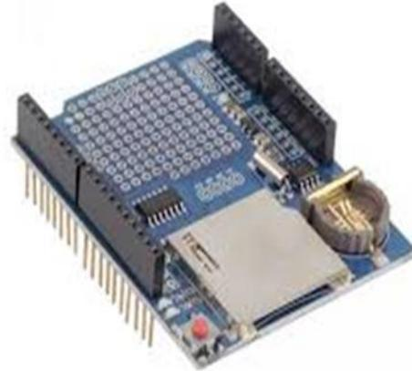
Fig 3 RTC module
