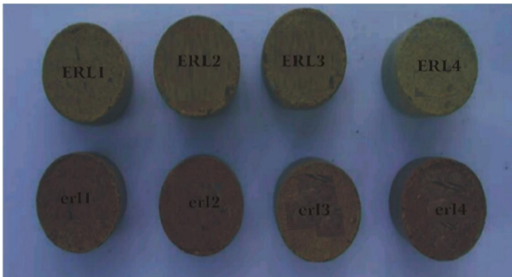
Figure 12: Colour change of clay samples before (erl1, erl2, erl3, erl4) after firing, (ERL1, ERL2, ERL3, ERL4)
