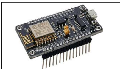
Fig.4. ESP8266 Wi-Fi Module
